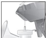
8. Mocno dociśnij pompkę **2** do kapturka ssącego **6** aż usłyszysz, że zaczep obrotowy **3** zatrzasnął się na kapturku (rys. **(e)**).
