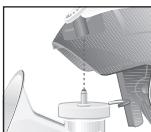
8. Drücken Sie die Pumpeneinheit **2** so kräftig auf die Absaughaube **6**, dass der Schwenkbügel **3** deutlich hörbar in der Absaughaube einrastet (Abb. **e**).
