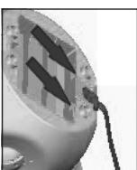
**Nota:** No se debe hacer funcionar el aparato sin la tapa del compartimento de pilas.
