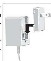
4. Schieben Sie den Stecker nach unten, bis die Verriegelung hörbar einrastet.
