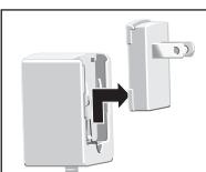
3. Setzen Sie den Wechselstecker mit seinen Nuten auf die Kontakte des Netzteiles.
